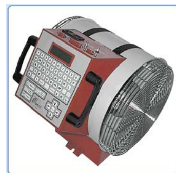
Naprava za merjenje zrakotesnosti Blower test 3000 z vgrajenim procesorjem izvedbe predpisanih meritev
